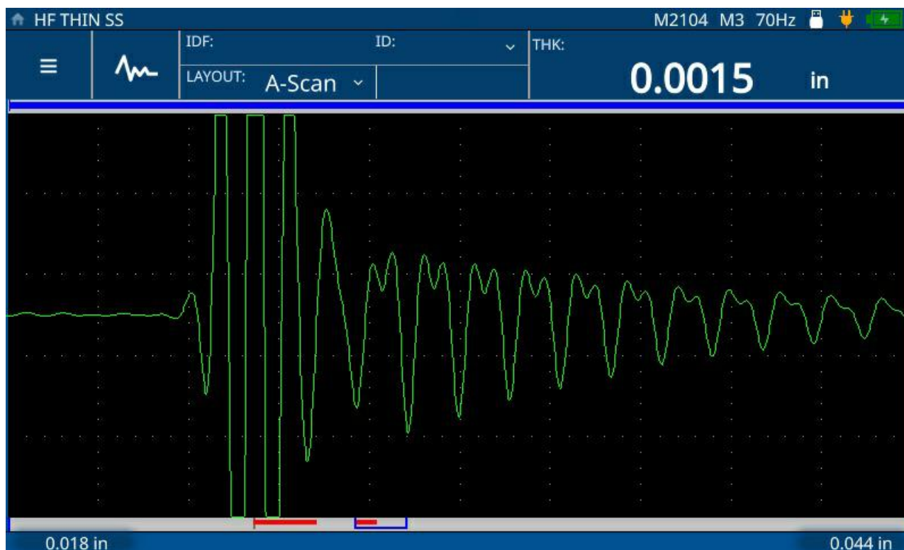
Měření tenké oceli (0,0381 mm neboli 0,0015 palce) tloušťkoměrem 72DL PLUS s použitím sondy M2104 (125 MHz)
